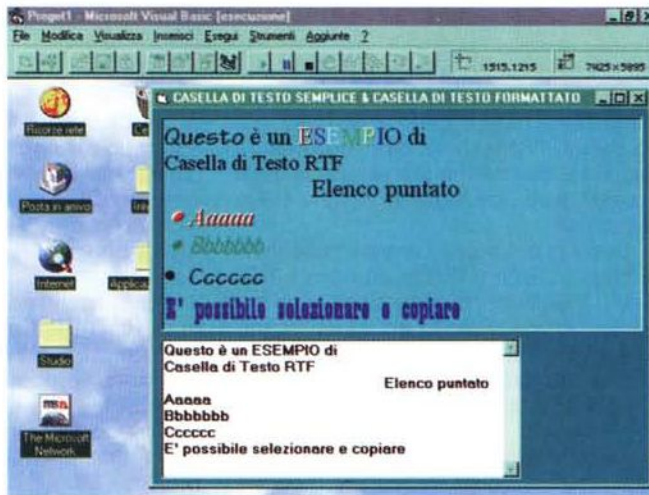
Figura 9 - MS Visual Basic 4.0 - Utilizzo della Box Rich Text Format. Un testo in formato RTF consiste in un file che contiene un testo e una serie di codici che indicano come il testo e le sue varie parti siano formattati. RTF è un formato testuale importante per una serie di motivi. È quello usato in entrata dai compilatori degli Help di Windows. È ottenibile anche con il comune WordPad di Windows 95. In Visual Basic 4.0 (solo con la versione 32 bit) è possibile creare una casella di testo e riempirla (metodo LoadFile) con un testo formattato. Se necessario, nell'applicazione VB è anche possibile inserire funzionalità per formattare «in proprio» lo stesso testo.
